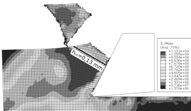
Rys. 7. Wyniki symulacji naprężeń zredukowanych Hubera-Misesa dla U_{f4} = 4,4 \cdot 10^{-6} wyznaczonego dla T = 1000^{\circ}\text{C}
