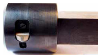
Rys. 2. Narzędzie do fazowania z ostrzem napinanym sprężyną śrubową
