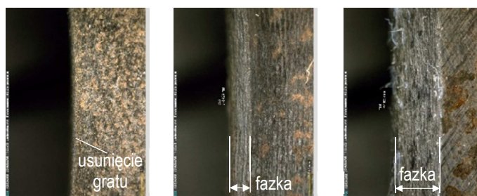
Rys. 3. Fazy wykonane w żeliwie w warunkach obróbki na sucho; wymiary fazek od lewej – brak fazki (usunięcie gratu), 0,6 \times 45^\circ , 1,45 \times 45^\circ
