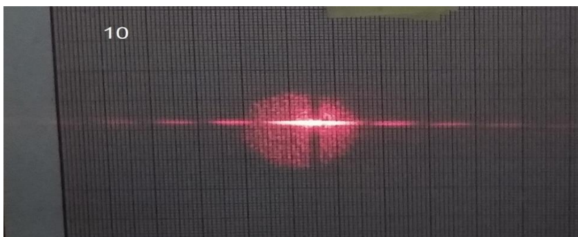
Rys. 3. Rozkład prążków dyfrakcyjnych dla włosa jasnego
