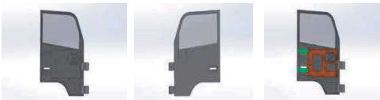
Fig. 2. Left doors of the N-Truck car and reinforce elements Rys.2. Drzwi lewej kabiny pojazdu N-Truck oraz element wzmacniający
