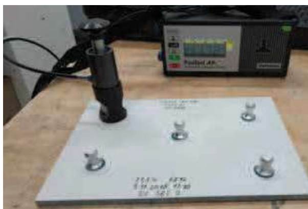
Fig. 2. Pull-off testing Rys. 2. Zrywanie próbki
