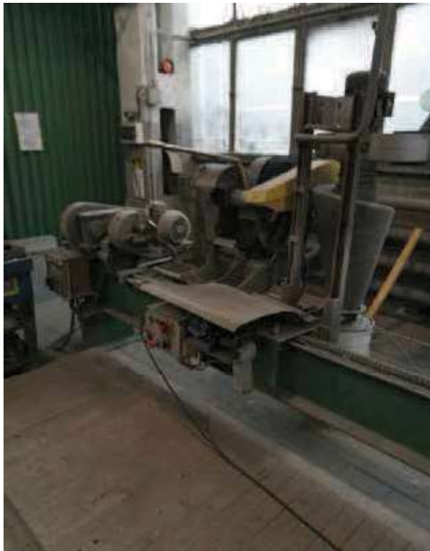
Fig. 3. Stand for cleaning lighting columns with disc blades Rys. 3. Stanowisko do czyszczenia słupów oświetleniowych tarczami listkowymi
