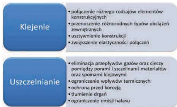
Rys. 4. Podstawowe funkcje klejów w budowie autobusów Fig. 4. Basic functions of adhesives in the buses construction
