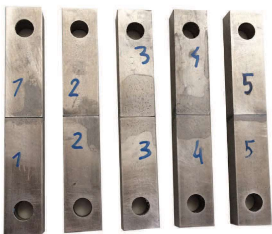
Rys. 1. Badane próbki stalowe łączone klejowymi spoinami doczołowymi
