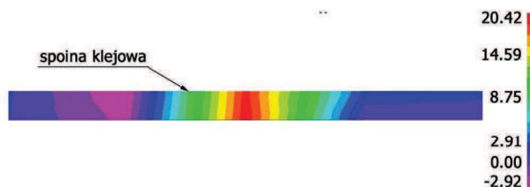
Rys. 3. Rozkład maksymalnych naprężeń głównych w spoinie klejowej
