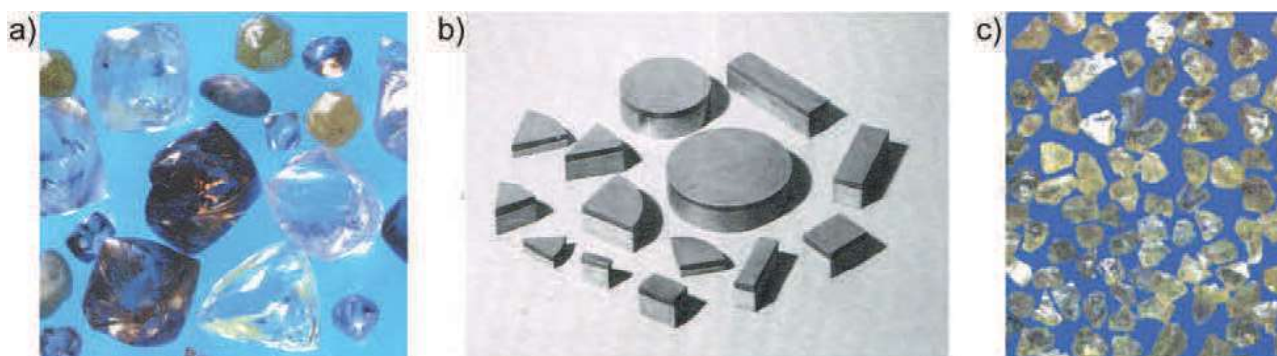
Rys. 1. Przykłady surowca diamentowego stosowanego w narzędziach do obróbki skrawaniem, kontrolno-pomiarowych i ścierno-polerskich: a) kryształy, b) materiały PCD, c) ziarna ściernie [12]
