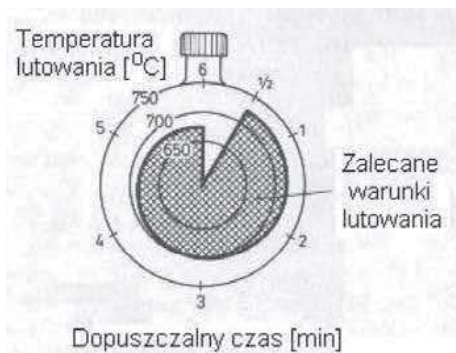
Rys. 3. Zalecanie warunki lutowania materiału SYNDITE™ (materiał PCD produkowany przez firmę Element Six) w stalowych korpusach narzędzi do obróbki skrawaniem [21]
