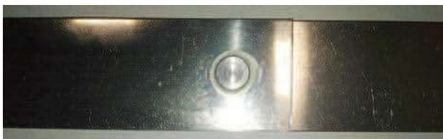
Rys. 4. Powierzchnia typowej spoiny wykonanej metoda RFSSW Fig. 4. The surface of the weld made method RFSSW
