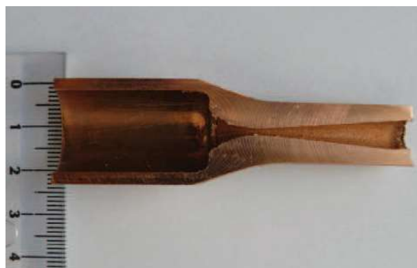
Rys. 6. Przekrój rury przewężonej obrazujący istnienie wewnętrznego stożka w części przewężonej Fig. 6. A cross-section of the throat showing the existence of the internal cone of the throat portion
