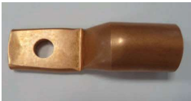
Rys. 8. Końcówka kablowa przed operacją bębnowania Fig. 8. Cable lug before barrel finishing
