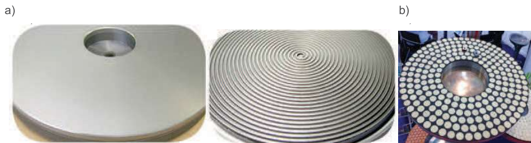
Rys. 3. Przykłady konstrukcji: a) tarczy docierającej gładkiej i rowkowanej spiralnie [5], b) narzędzia ścierno-metalowego [3] Fig. 3. Examples of the construction: a) of reaching smooth and grooved spirally shield [5], b) of abrasive-metal tool [3]
