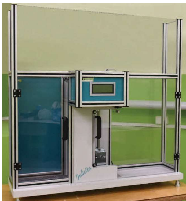
Rys. 2. Urządzenie do badań udarności połączeń klejowych „Julietta”
