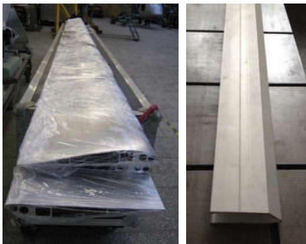
Rys. 1. Obiekty badań – duralowa łopata wirnika nośnego wiatrakowca (po lewej), kieszeń łopaty (po prawej)
