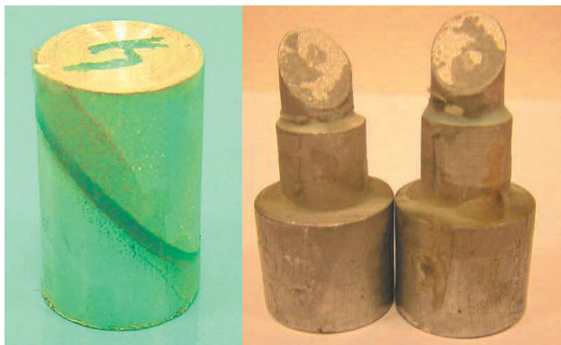
Fig. 2. Adhesively bonded cylindrical skew specimen for compressive test and specimens after tensile test Rys. 2. Sklejona próbka cylindryczna skośna przeznaczona do badań na ściskanie oraz zerwana, obciążona na rozciąganie
