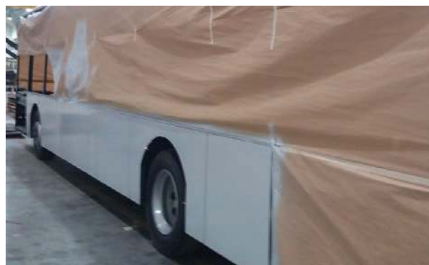
Rys. 4. Widok autobusu przeznaczonego do malowania z zabezpieczonymi powierzchniami
