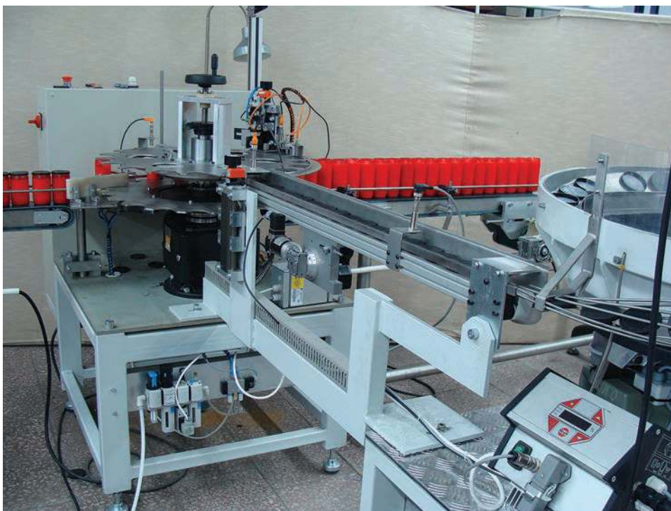
Rys. 2. Urządzenie do napełniania zniczy. Wsporniki, blaty lub stół obrotowy maszyny są elementami o potencjale zastosowania kompozytów
