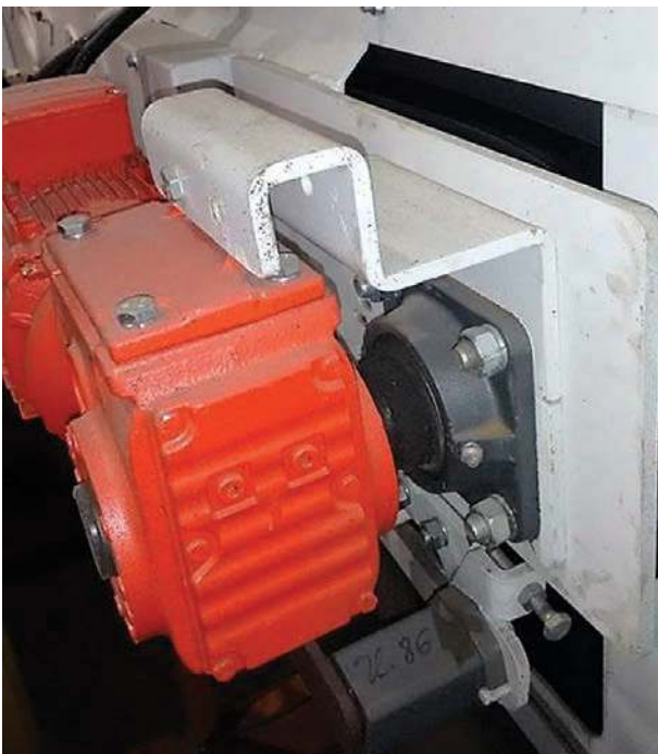
Rys. 1. Mocowanie motoreduktora za pomocą uchwytu giętego [4] Fig. 1. Fixing the gear motor with the handle bent [4]
