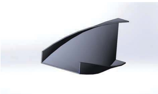
Рисунок 3. Желоб с изгибом в горизонтальной плоскости Fig. 3. Curved guide channel in horizontal plane
