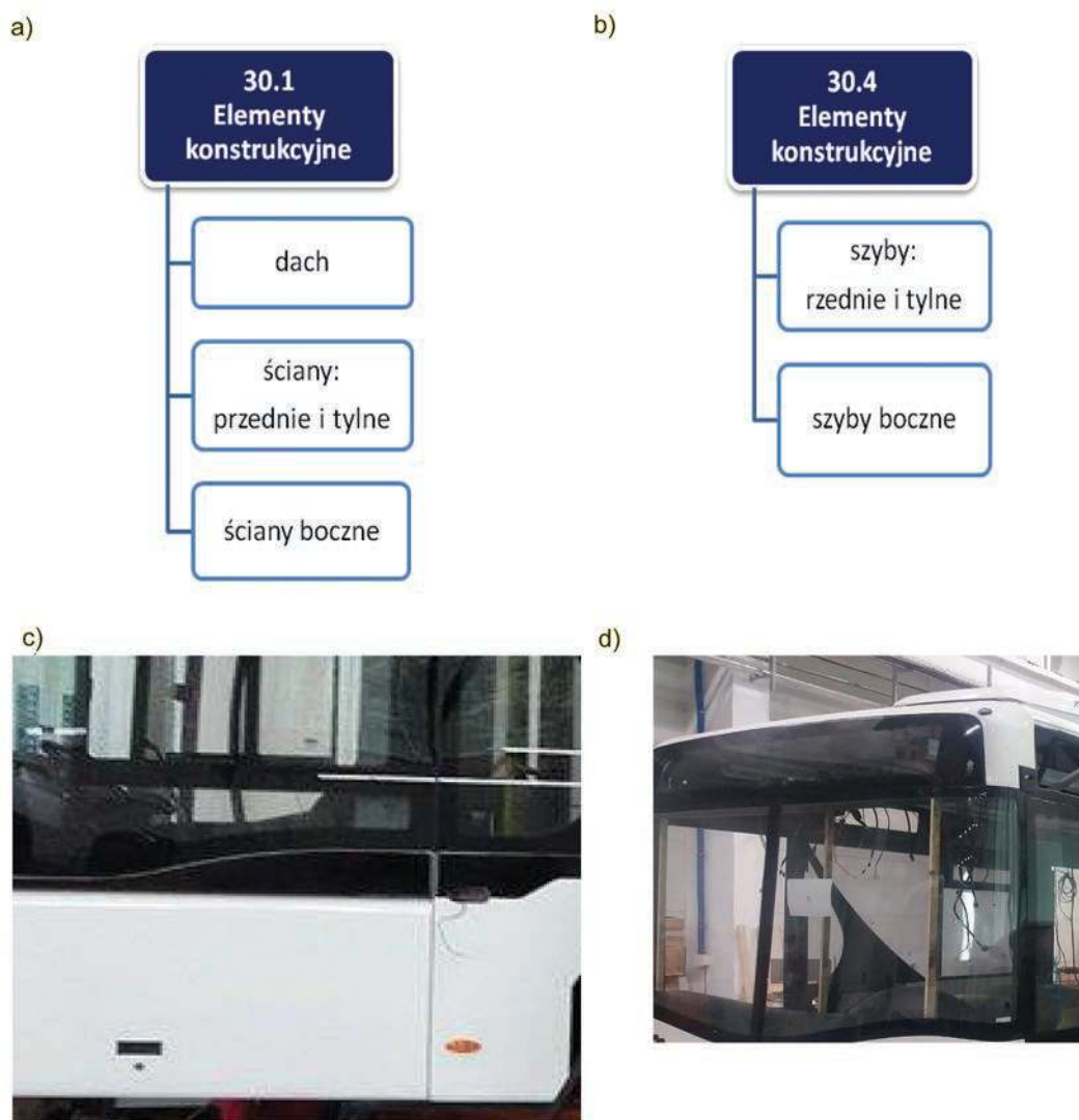
Rys. 2. Operacja montażu elementów zabudowy zewnętrznej: a, b) elementy montowane w operacji montażowej nr 30, c) widok ściany bocznej, d) widok szyby przedniej Fig. 2. Assembly operation of external elements: a, b) elements assembled in no. 30 assembly operation, c) side wall view, d) view of the windscreen
