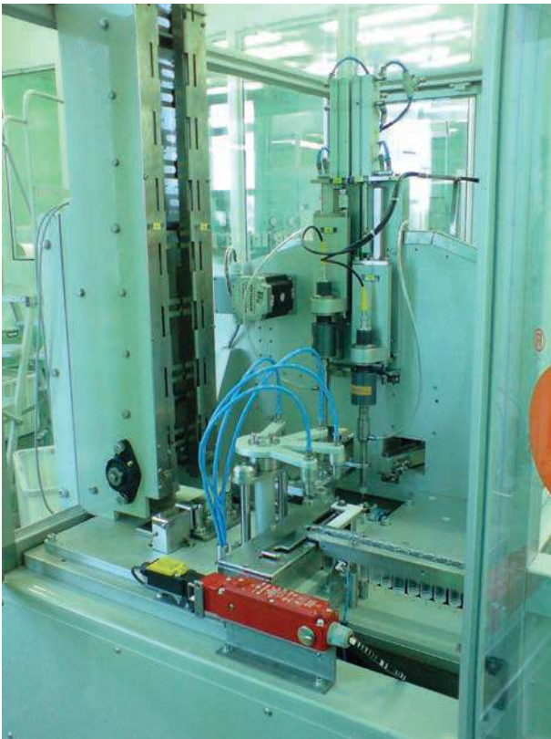
Rys. 3. Urządzenie do montażu pojemników „dozowników medycznych kroplówek” w przyrządach do infuzji. Blaty, ściany grodziwe, kolumnę lub ramie podające ciecze można wykonać wykorzystując kompozyty
