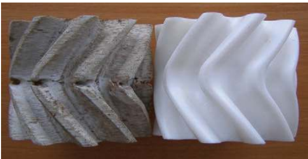
Рисунок 9. Изношенное и изготовленное зубчатые колеса Fig. 9. Worn and manufactured gears
