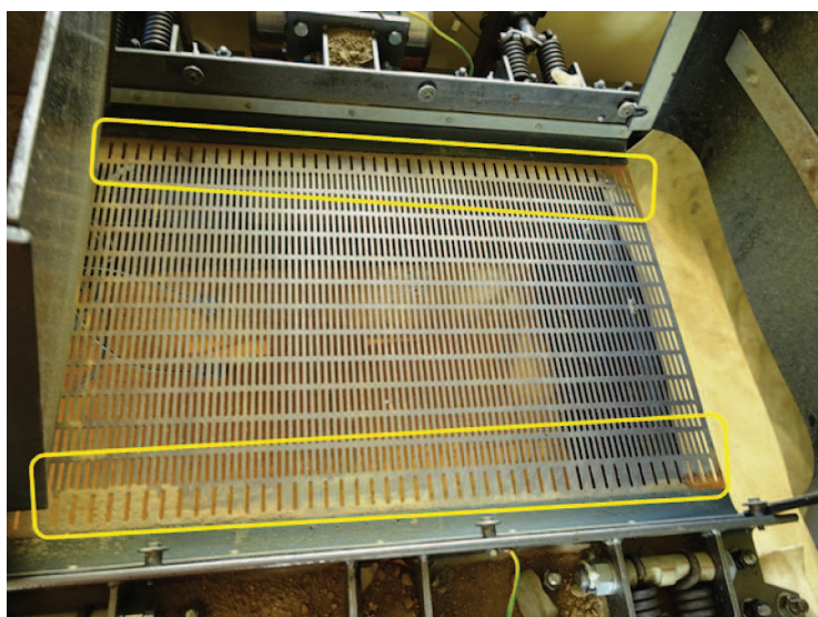
Rys. 1. Fotografia sita przesiewacza z uwzględnieniem miejsc najbardziej narażonych na pękanie Fig. 1. Photograph of screen sieve taking into account places most prone to fracture
