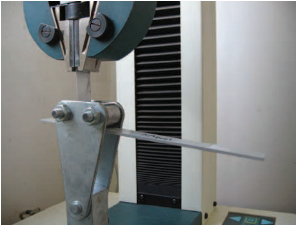
Rys. 4. Widok badanej próbki oraz przyrządu wymuszającego stan oddzierania
