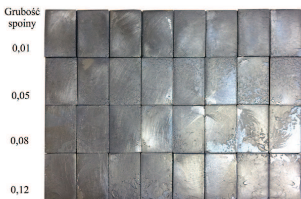
Rys. 4. Powierzchnie zniszczenia spoin klejowych przedstawione zależnie od ich grubości Fig. 4. Fracture surface of adhesive joints shown depending on their thickness
