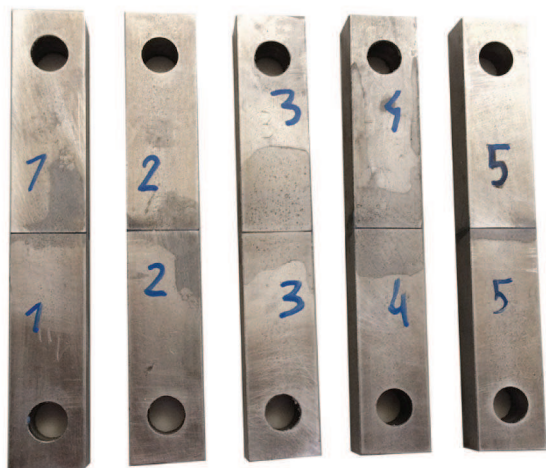
Rys. 1. Badane próbki stalowe łączone klejowymi spoinami doczołowymi
