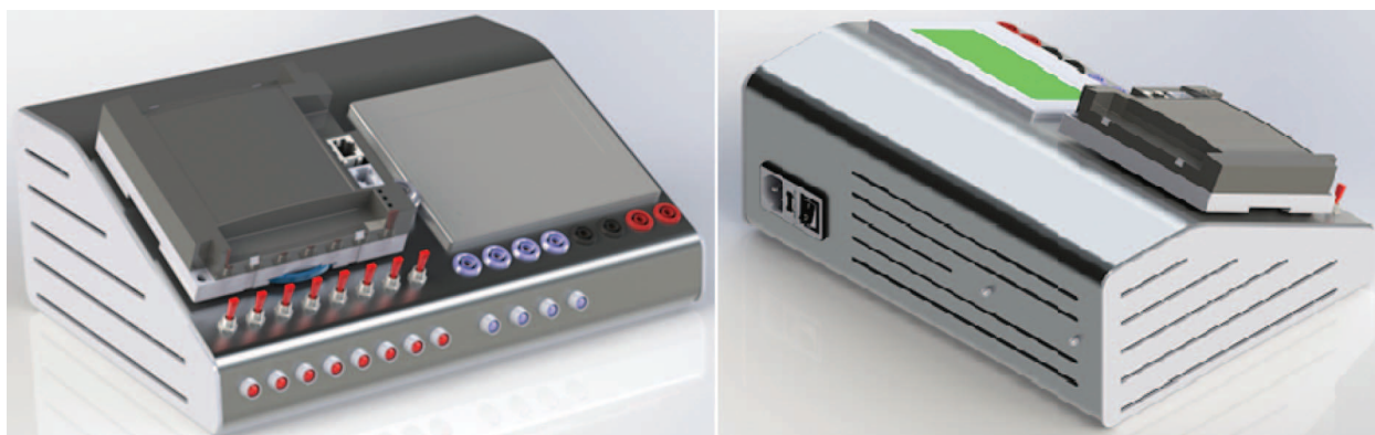
Rys. 1. Wizualizacja stanowiska wyposażonego w sterownik PLC oraz panel operatorski HMI Fig.1. Visualization of the desktop with PLC controller and HMI operator's panel
