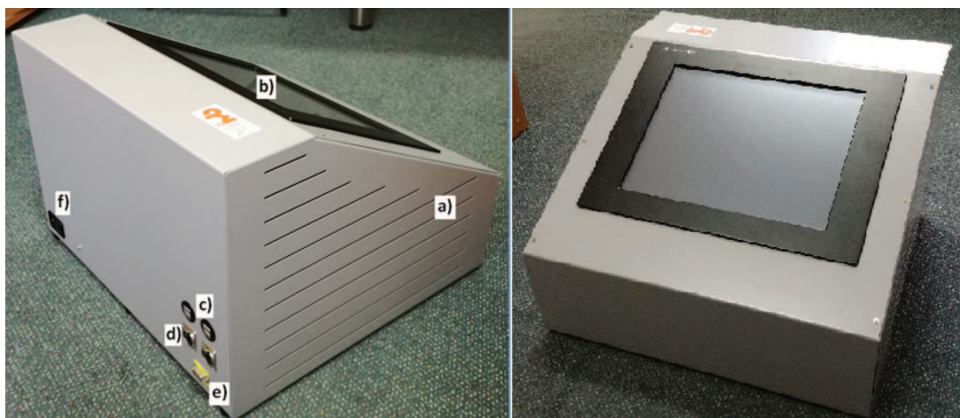
Rys. 5. Stanowisko pulpitowe z komputerem przemysłowym: a) obudowa stanowiska, b) komputer przemysłowy klasy PC typ AS47C15, c) dwa porty USB, d) dwa podwójne porty sieciowe Ethernet, e) jeden port RS232, f) gniazdo sieciowe 230VAC 50Hz z wyłącznikiem i bezpiecznikiem aparaturowym
