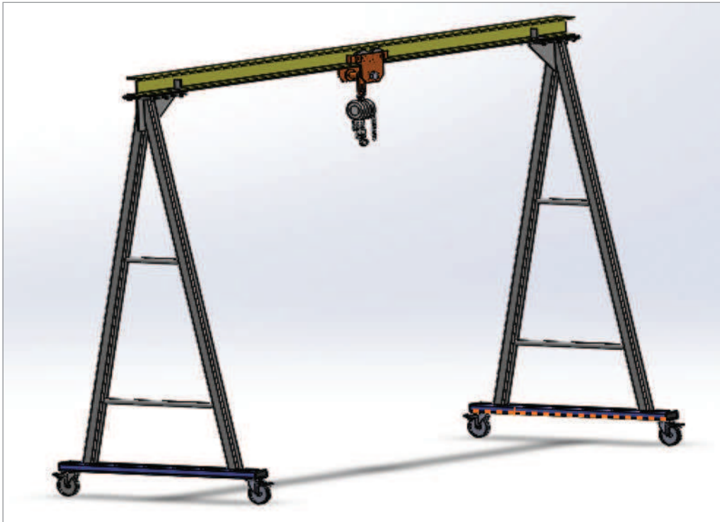
Rys. 2. Projekt wyciągarki bramowej w firmie ELEKTROBUDOWA SA (opracowanie własne) Fig. 2. The project winch gantry company ELEKTROBUDOWA SA company (self study)
