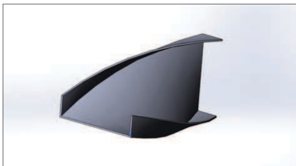
Рисунок 3. Желоб с изгибом в горизонтальной плоскости Fig. 3. Curved guide channel in horizontal plane
