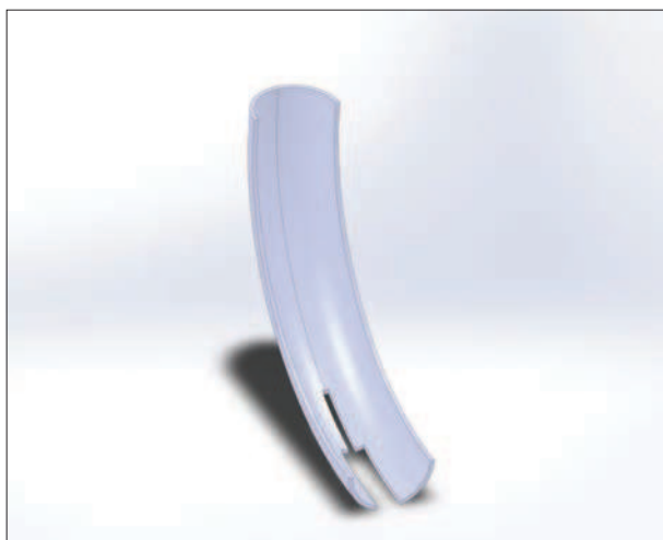
Рисунок 1. Желоб с изгибом в вертикальной плоскости Fig. 1. Curved guide channel in vertical plane
