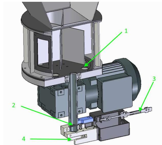
Fig. 8. Washer feeder
