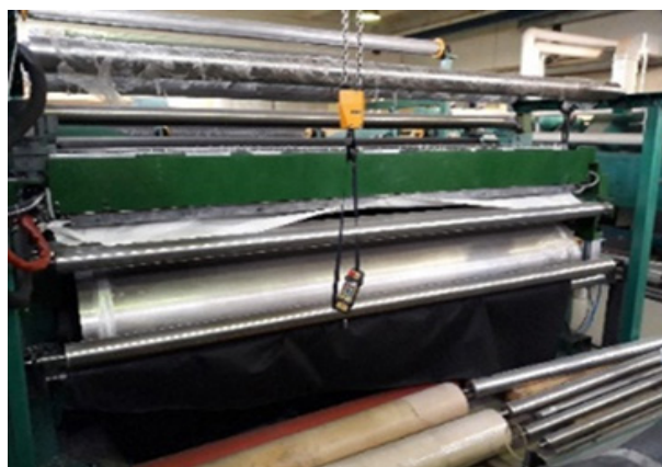
Rys. 10. Układ zabudowy głowicy dozującej z zamontowanym płytowym zespołem kompensacji prostoliniowości głowicy w maszynie laminującej Fig. 10. The layout of the structure of the dispensing head with the panel system for the head alignment compensation in a laminating machine
